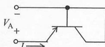
$$I = I_E = I_{F0} \left( e^{qV_{EB}/kT} - 1 \right) - \alpha_R I_{R0} \left( e^{qV_{CB}/kT} - 1 \right)$$
